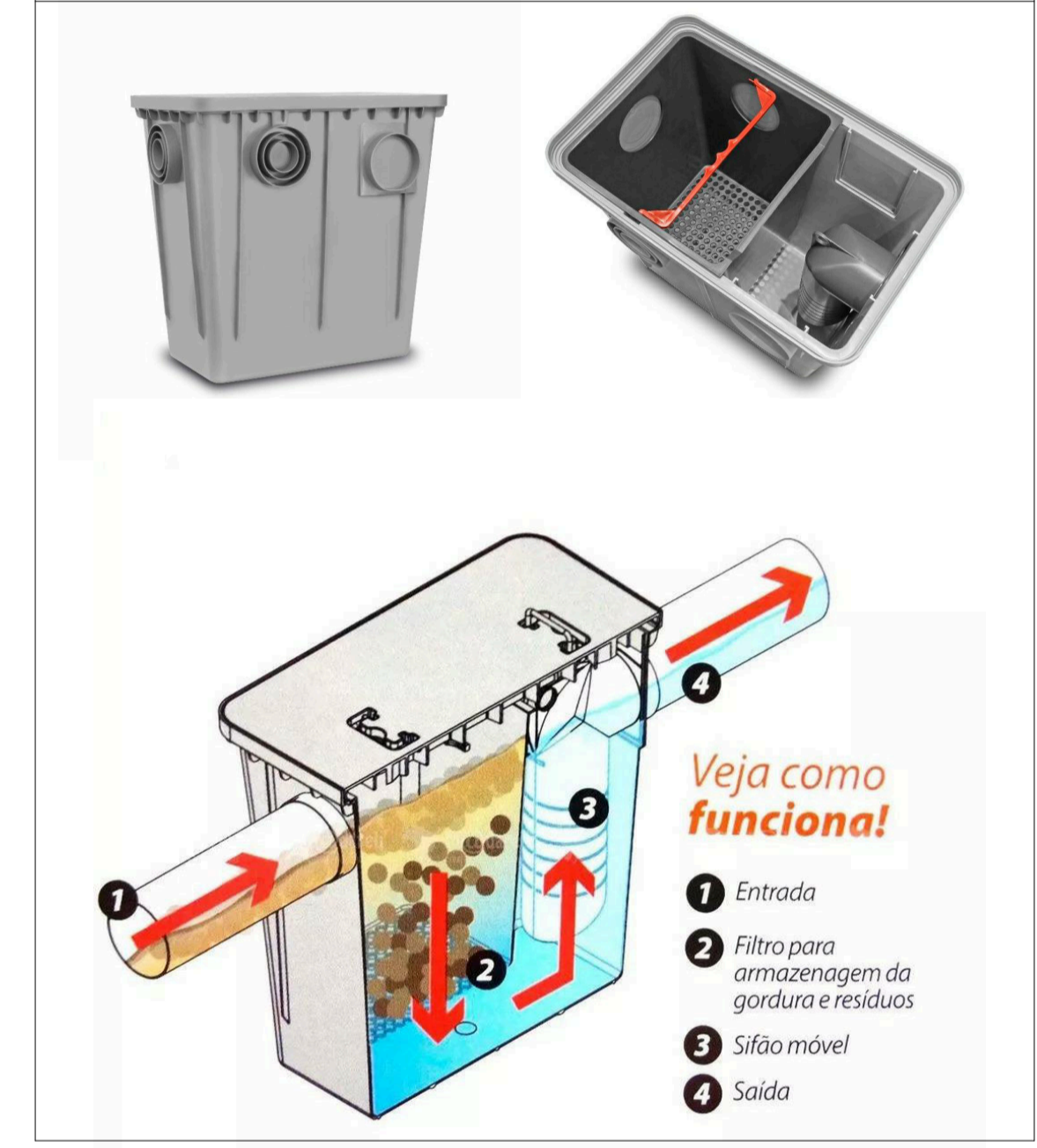
Detalhes - Caixa de Gordura Simples (CGS) - 52 Litros - ROMA
