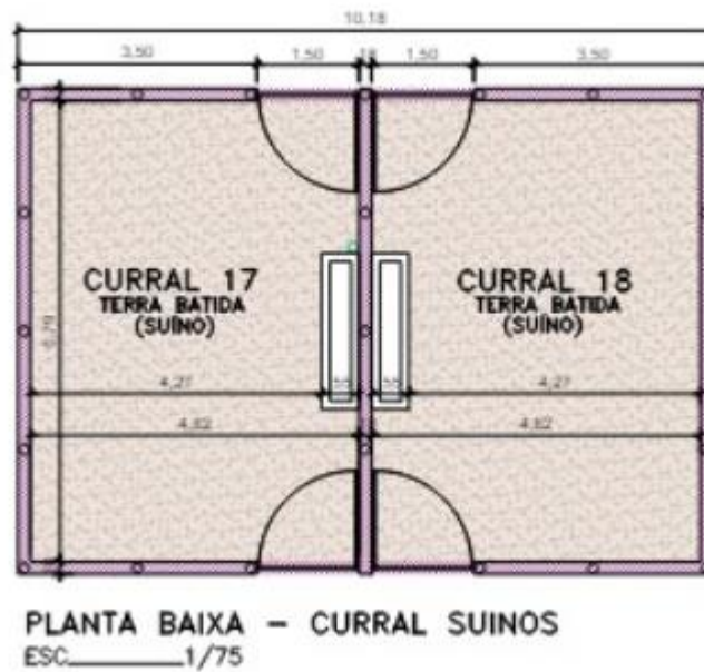
Imagem nº 04 – Planta Baixa dos Currais de Suínos da Feira de Gado de Toritama, Fonte: Autor, 2024
